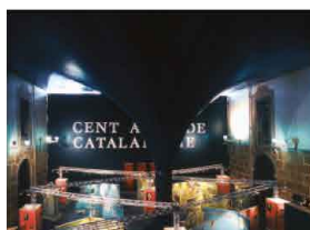
Cubierta sin estructura ni cables con forma de embudo: fijada perimetralmente a la pared a través de una guía, y el cuello del embudo tensado y fijado al suelo actuando de desagüe de la cubierta.
